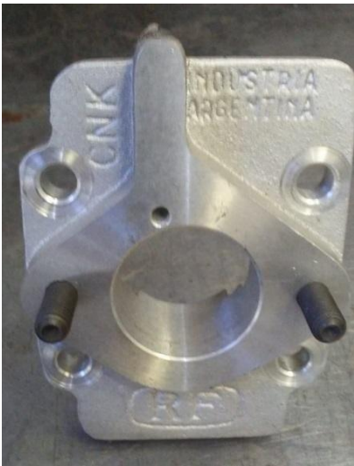
Porta carburador para flapera chica: Se permite modificar el radio de descarga de flujo
